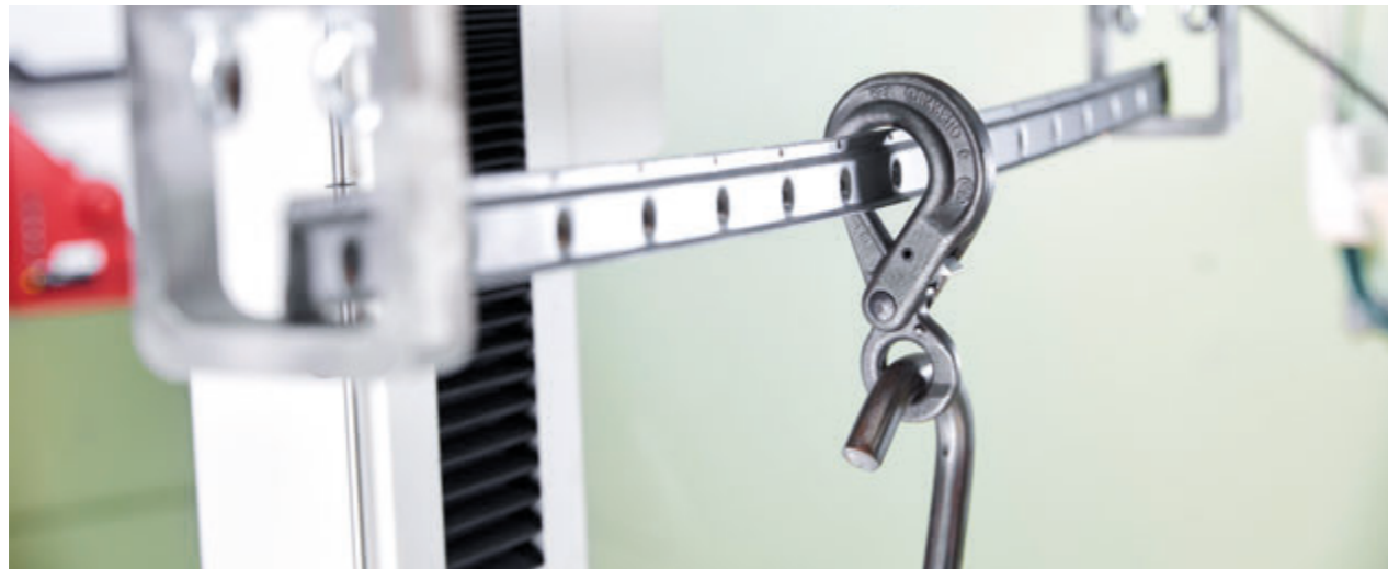
サスペンションビームの耐荷重試験
